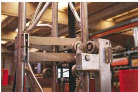
I Tralicci Verticali sono uniti fra di loro a mezzo di quattro viti ad occhio che rimangono fisse sullo stesso rendendo così veloce e sicuro il montaggio ed eliminando così il rischio della perdita. Sul traliccio è avvitata la cremagliera di scorrimento.
