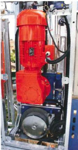
Il Gruppo di Sollevamento scorre su un Traliccio Verticale (entrambi zincati a caldo) a mezzo di una serie di coppie di rulli montati su carrelli basculanti per distribuire la pressione in modo omogeneo e meno usurante ed avere così una corsa più morbida e una vita più lunga dei tralicci. Al centro è installato il motoriduttore a due velocità o monofase, il sistema di sovraccarico ed il paracadute di sicurezza anticaduta.
