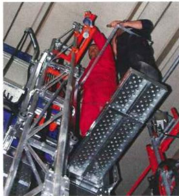
La rampa di montaggio facilita le operazioni sia di fissaggio del traliccio che l'esecuzione dell'ancoraggio a parete e può essere posizionata su entrambi i lati della piattaforma.
