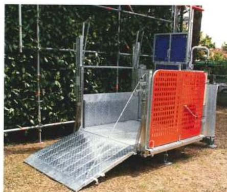
La rampa di Ingresso può essere installata sia sul lato A, B e C mentre la Rampa di Uscita su A e B con un sistema di barre di controllo o ad apertura verticale o laterale. La rampa di ingresso può essere sostituita da un cancello pieghevole per permettere un facile carico della piattaforma con mezzi di sollevamento o quando l'utilizzo è prevalentemente come Piattaforma di Trasporto. Il terzo lato è previsto con un parapetto fisso o in alternativa con rampa o porta.
