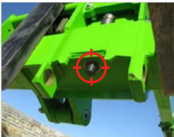
Tac-Lock: sistema di bloccaggio idraulico dell'attrezzo dalla cabina
