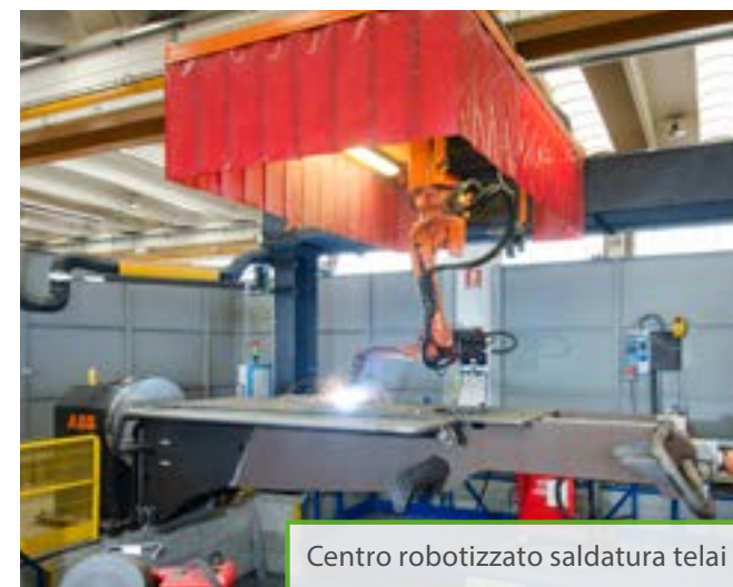
Nuovo centro a doppia robotizzazione automatizzato e ad alta precisione
