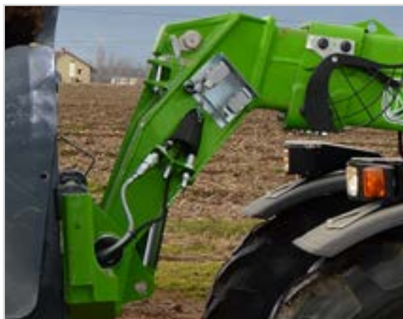
Tubazioni, cavi elettrici e linee idrauliche ausiliarie sono collocati all'interno del braccio
